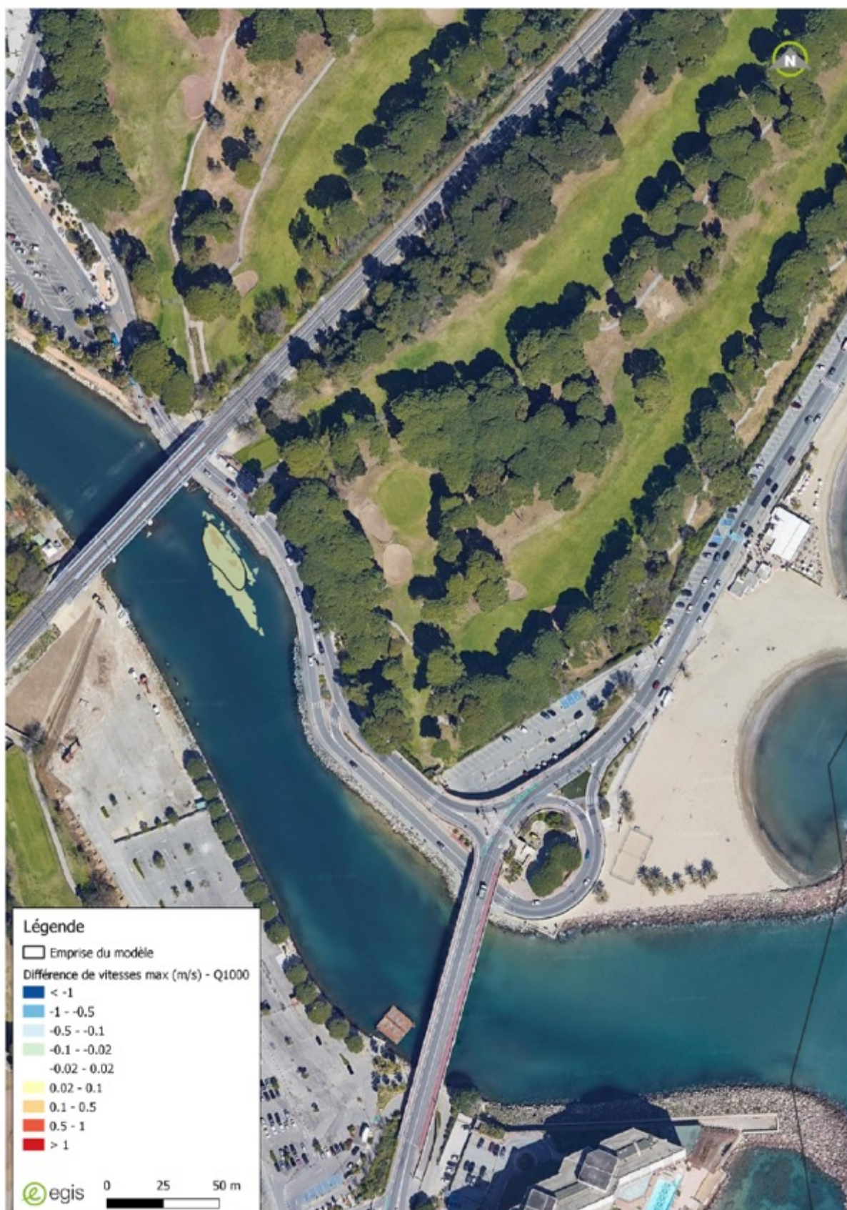
Figure 37 : cartographie différence des vitesses max après travaux avec/sans comblement de la fosse en enrochement Q1000 (modèle EGIS)
