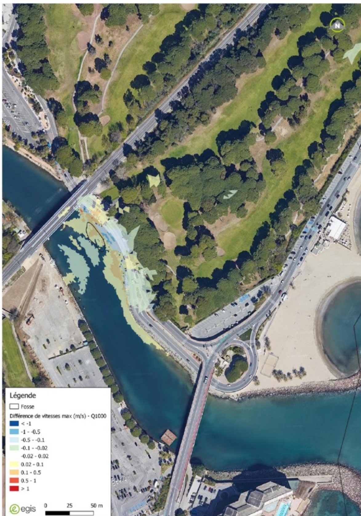
Figure 39 : cartographie différence de vitesse max avant/ après travaux avec comblement de la fosse en enrochement Q1000 (modèle EGIS)
